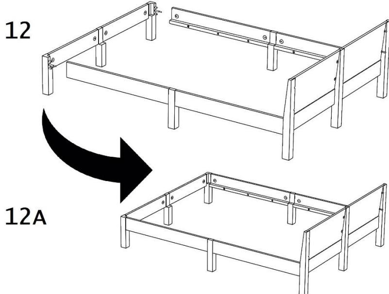
**PL** | Połącz wcześniej złożony front z pozostałą częścią ramy łóżka **12A**.**ENG** | Attach footboard to the bed frame as shown in the picture **12A**.**DE** | Befestigen Sie das Trittbrett wie in Abbildung **12A** gezeigt am Bettrahmen.**CZ** | Připojte stuhačku k rámu postele, jak je znázorněno na obrázku **12A**.
