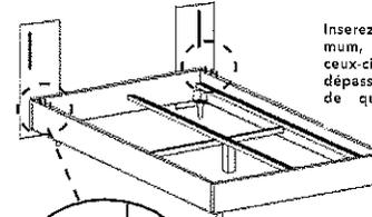
Insérez-les au maximum, une fois installés ceux-ci doivent encore dépasser de la planche de quelques centimètres.
